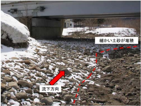
写真-16 広尾川土砂堆積状況 (土砂中の塩化物イオンは 0.01% Cl - )
