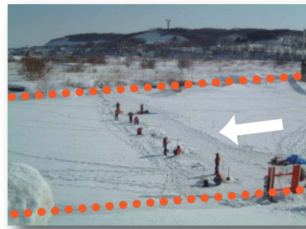
従来の氷の張った川における 流量観測の状況(北海道開発局提供)
