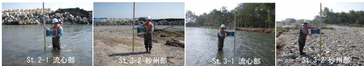
写真 4-2 河床材料採取状況
