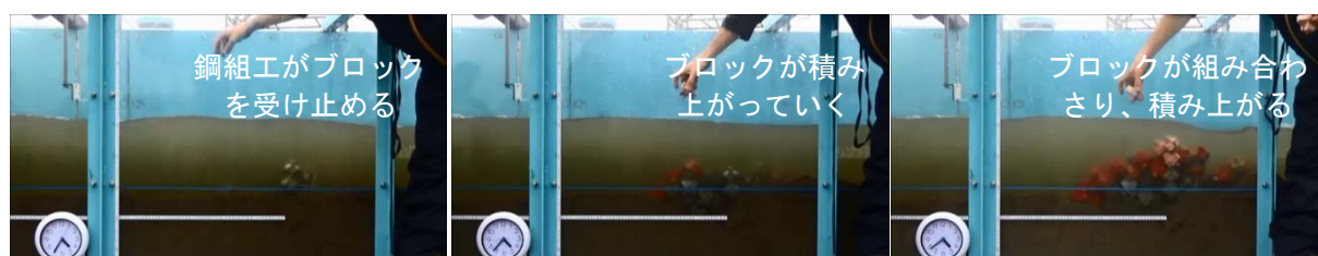
写真 4.9 鋼組工の模型実験の状況
