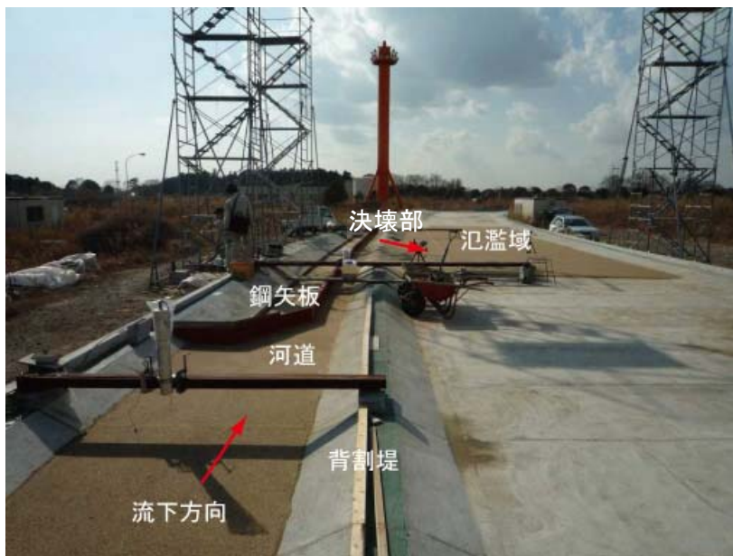
写真 2.7 つくば市にある縮尺模型（現地の 1/20）
