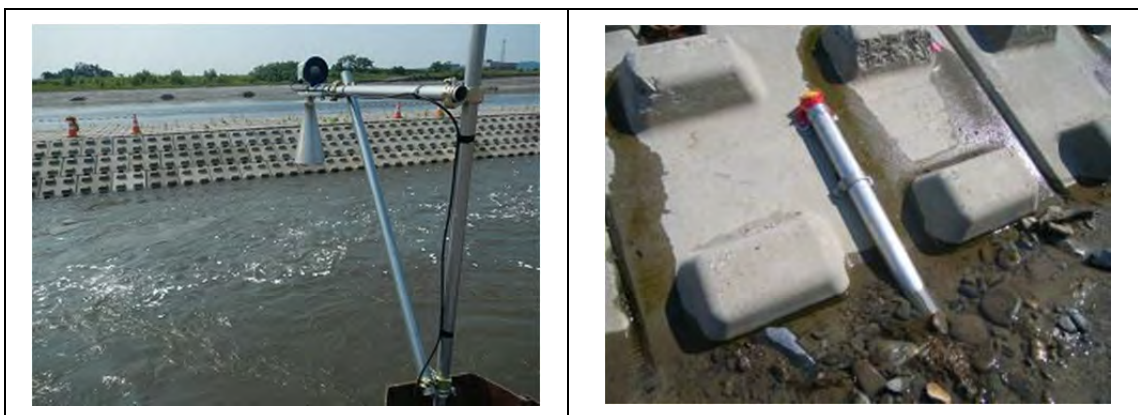
図 2-1 設置状況および外観（左：電波式水位計、右：水圧式水位計）
