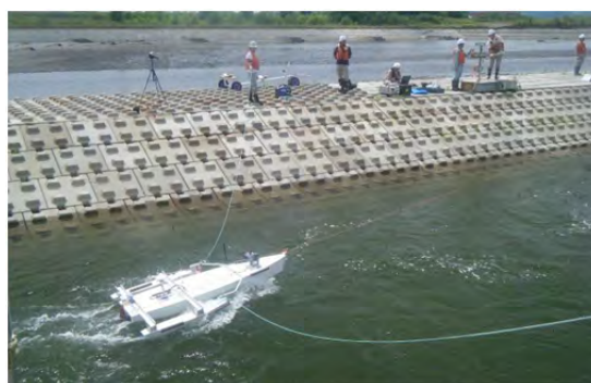
図 2-7 ADCP による横断観測
