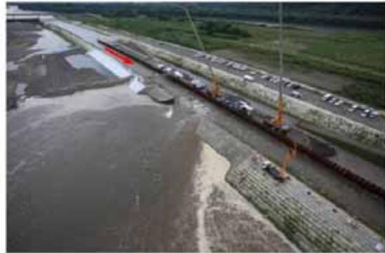
破堤進行過程 (t=56min)
