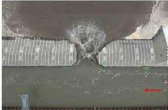
破堤進行過程 (t=29min)
