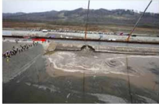
破堤進行過程 (t=53min)
