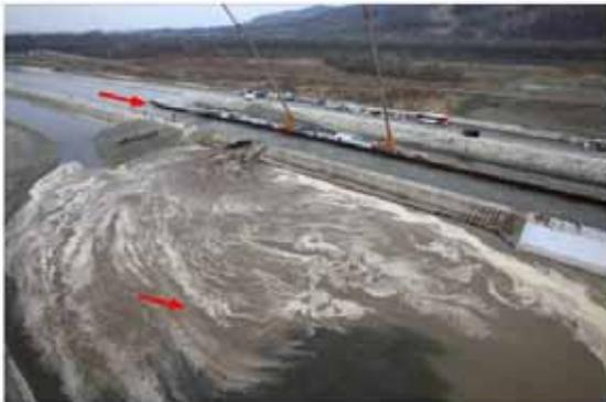
破堤進行過程 (t=67min)
