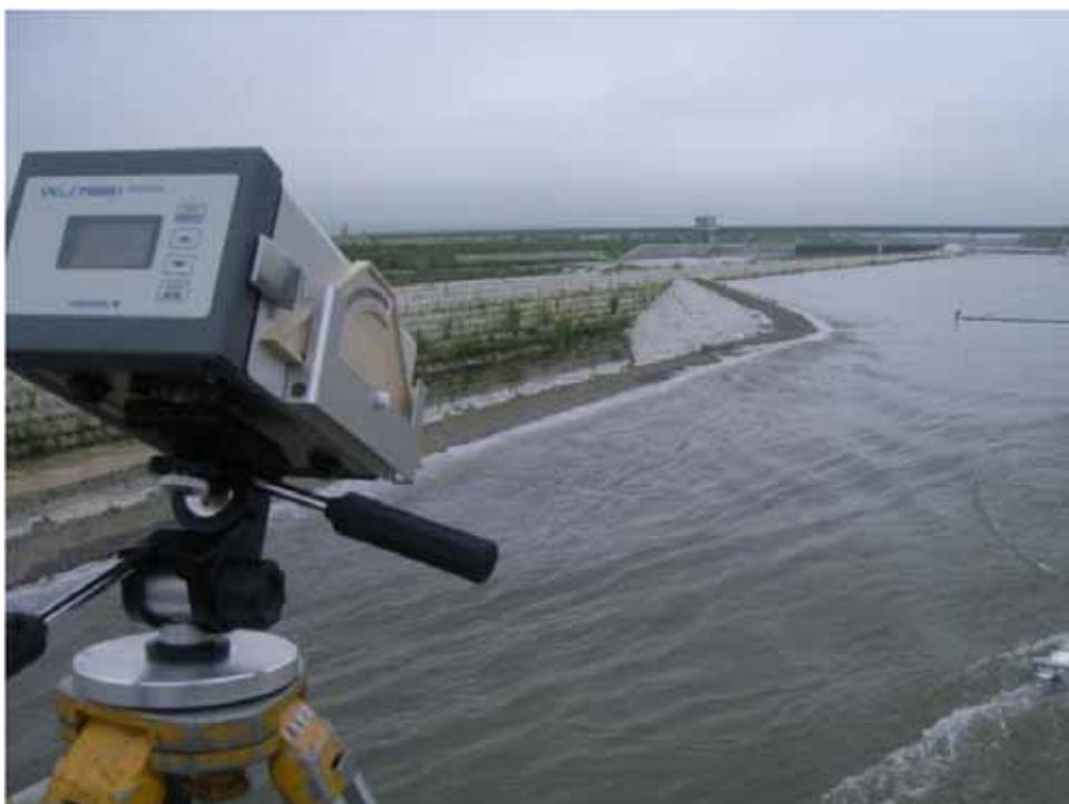
写真- 25 電波式流速計
