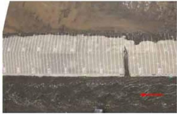
破堤進行過程 (t=10min)
