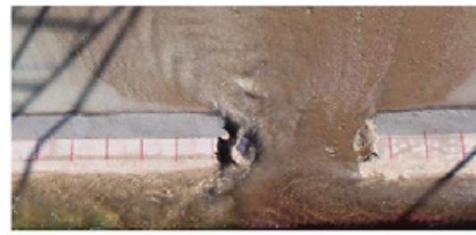
破堤幅 ≒ 30m (t=45min)
