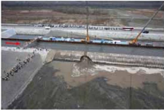
破堤進行過程 (t=31min)
