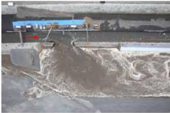
破堤進行過程 (t=72min)
