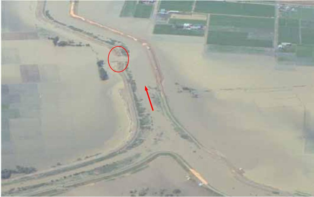
写真- 9 破堤状況 (⑩大鳳川)
