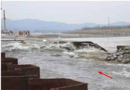
破堤進行過程 (t=69min)
