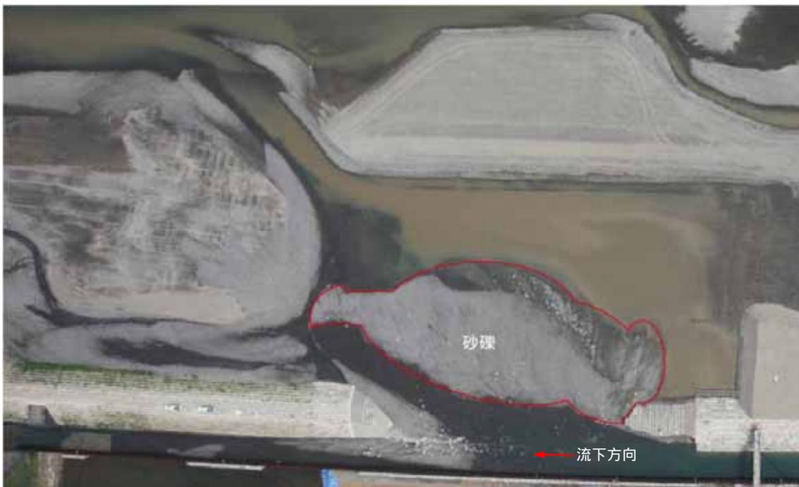
図- 89 通水終了後の氾濫域の土砂堆積状況 (Case4)
