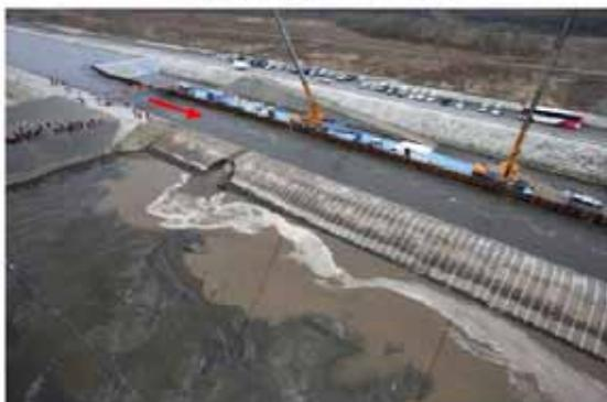
破堤進行過程 (t=27min)
