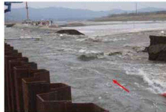
破堤進行過程 (t=78min)
