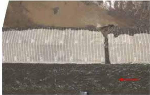
破堤進行過程 (t=20min)
