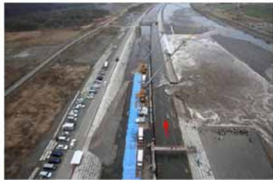
破堤進行過程 (t=70min)
