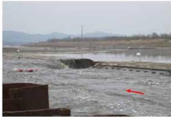
破堤進行過程 (t=65min)
