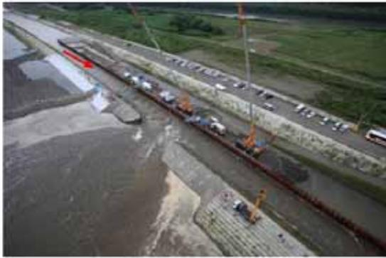
破堤進行過程 (t=52min)
