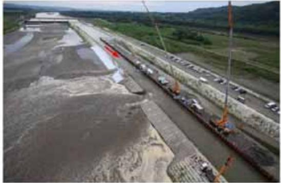
破堤進行過程 (t=34min)
