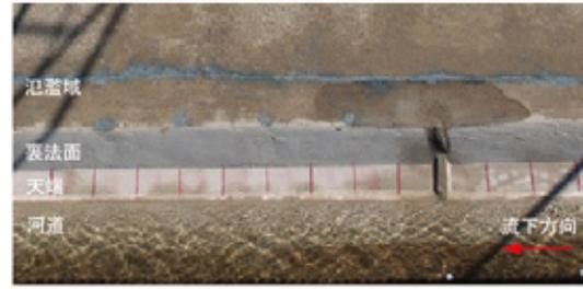
破堤幅 ≒ 19m (t=34min)
