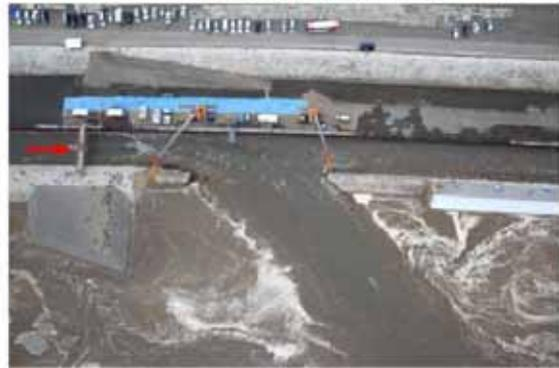
破堤進行過程 (t=83min)
