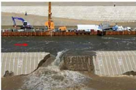
破堤進行過程 (t=17min)
