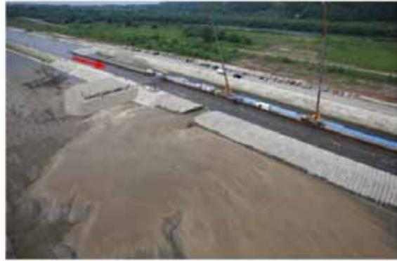
破堤進行過程 (t=50min)
