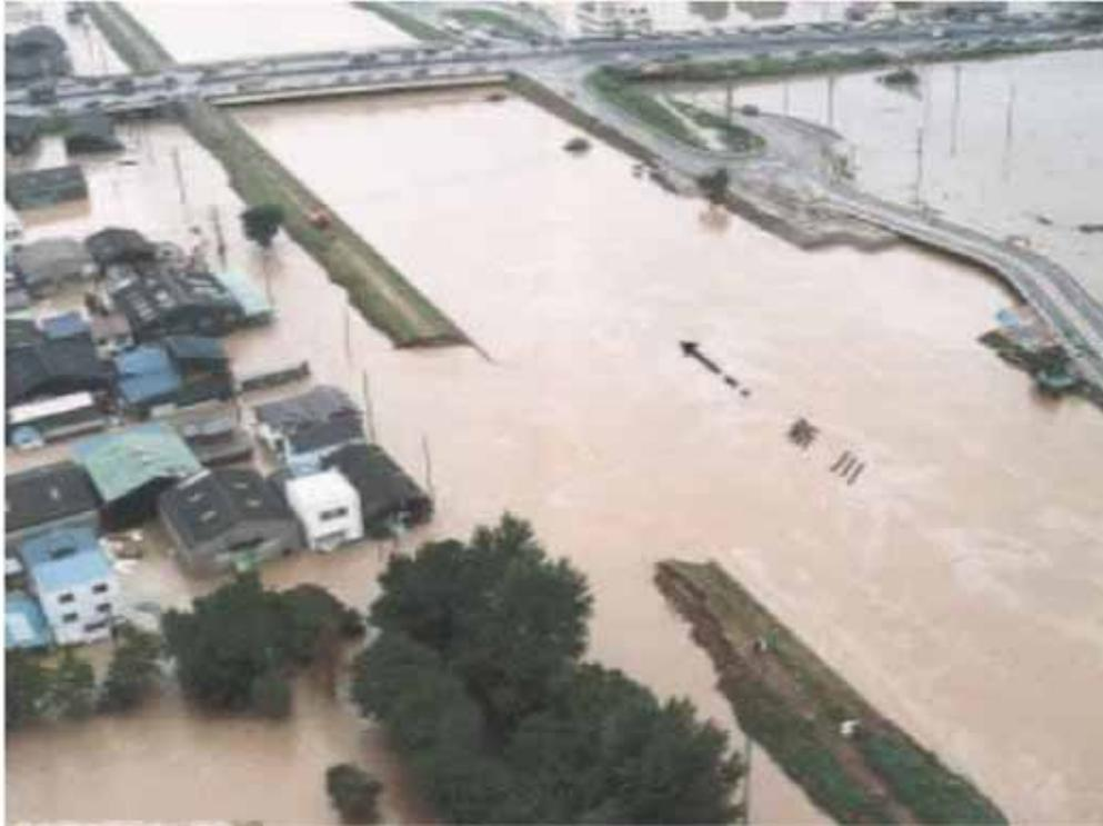
写真- 12 破堤状況（新川） ※愛知県河川堤防緊急強化検討会報告書より引用
