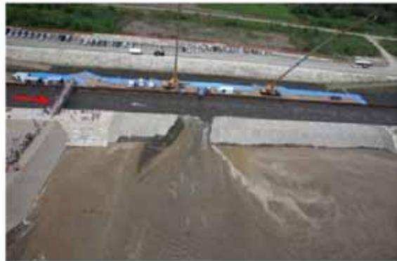
破堤進行過程 (t=54min)
