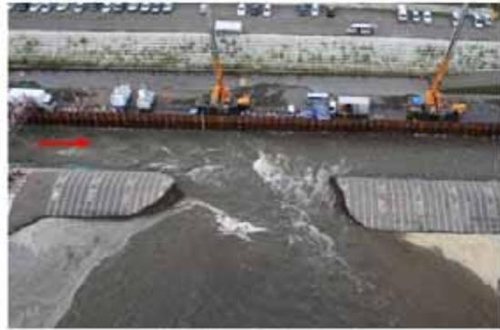
破堤進行過程 (t=52min)
