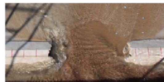
破堤幅 ≒ 39m (t=56min)
