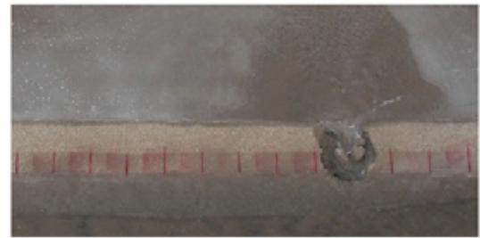
破堤幅 ≒ 21m (t=96min)
