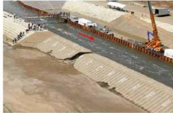
破堤進行過程 (t=14min)
