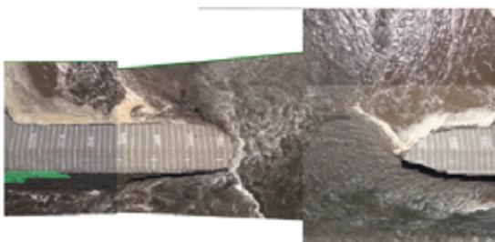
破堤幅 ≒ 40m (t=39min)
