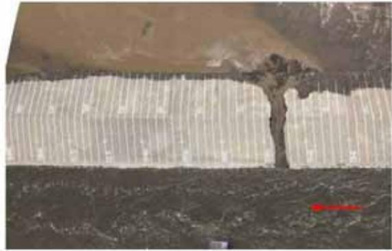
破堤進行過程 (t=30min)
