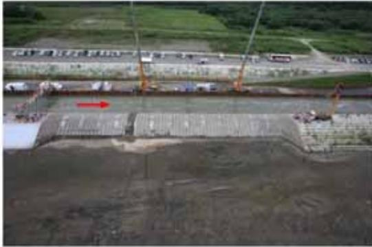
破堤進行過程 (t=2min)
