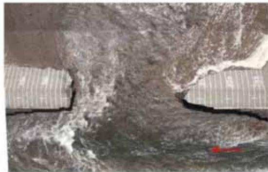
破堤進行過程 (t=29min)
