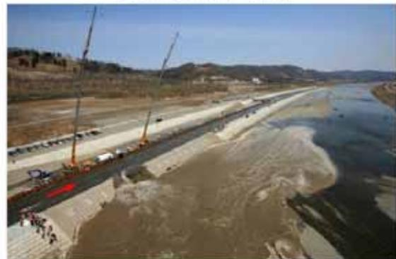
破堤進行過程 (t=18min)
