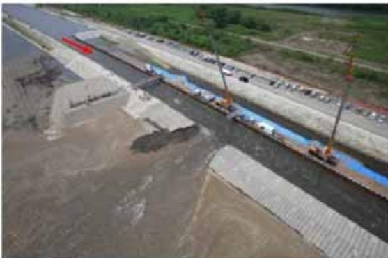
破堤進行過程 (t=57min)
