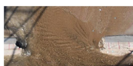
写真- 51 破堤状況 (模型 C1-2)
