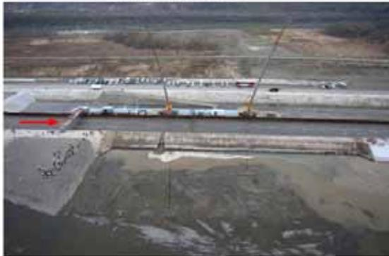
破堤進行過程 (t=6min)
