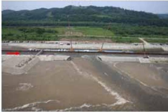
破堤進行過程 (t=69min)
