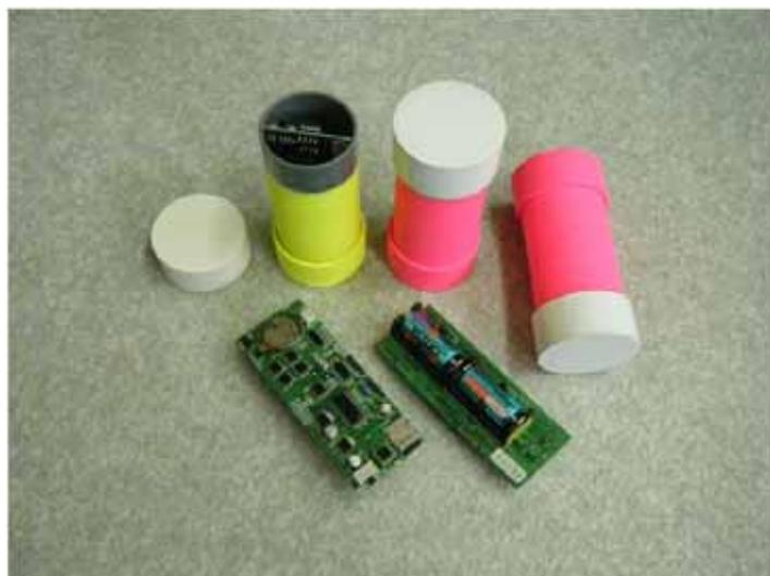
写真- 18 改良型加速度センサー
