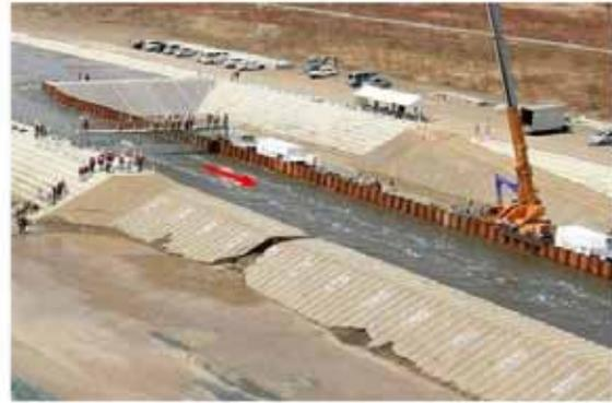
破堤進行過程 (t=11min)
