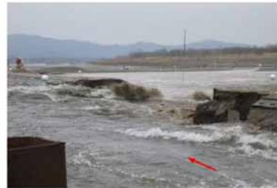
破堤進行過程 (t=70min)
