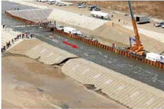
破堤進行過程 (t=13min)
