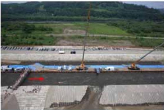
破堤進行過程 (t=52min)
