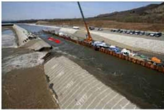
破堤進行過程 (t=20min)
