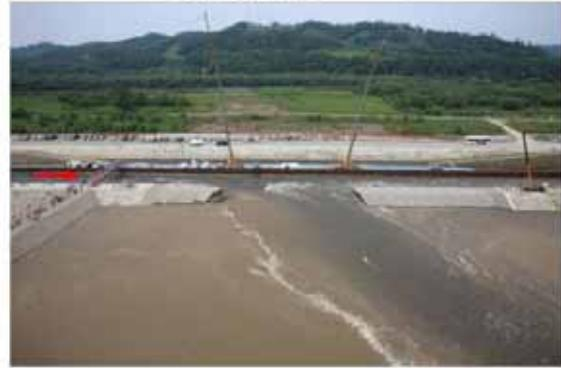
破堤進行過程 (t=73min)
