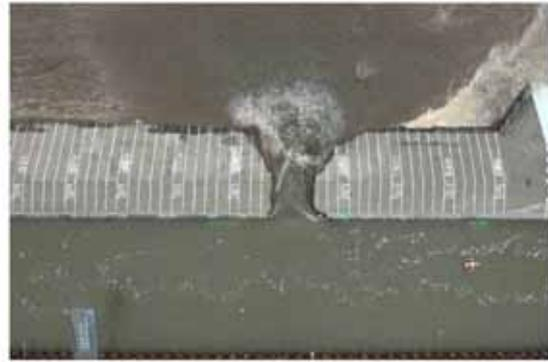
破堤進行過程 (t=25min)
