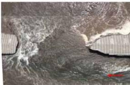
破堤進行過程 (t=33min)
