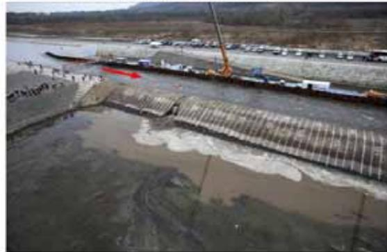
破堤進行過程 (t=9min)
