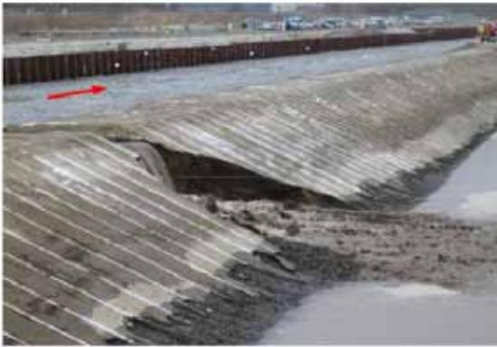
破堤進行過程 (t=29min)
