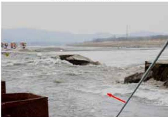
破堤進行過程 (t=71min)
