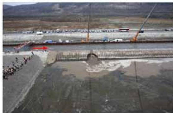
破堤進行過程 (t=28min)
