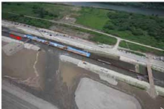
破堤進行過程 (t=76min)
