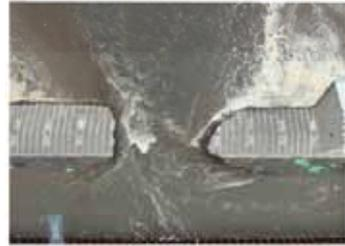
破堤幅 ≒ 22m (t=49min)
