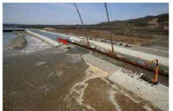
破堤進行過程 (t=35min)
