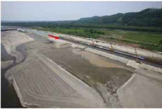
破堤進行過程 (t=46min)
