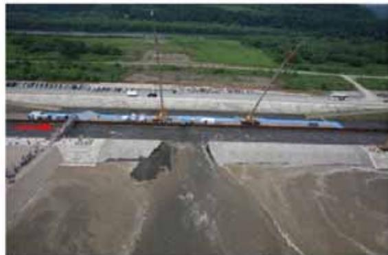
破堤進行過程 (t=58min)
