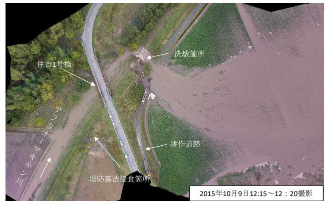
写真-17 サラカオーマキキン川の堤防決壊箇所 14) (一部加筆)
